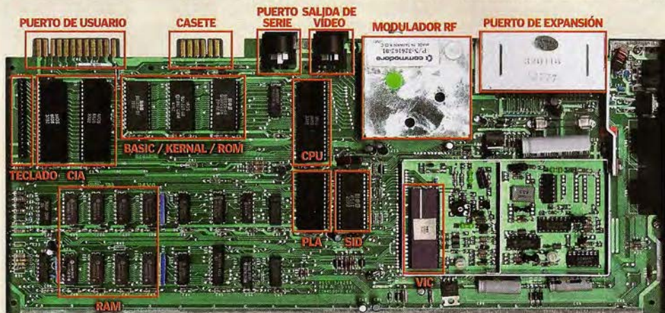
PLACA BASE, MODELO DE 1982. Los primeros modelos de C64 incorporaban una placa base cuya arquitectura estaba pensada al milímetro, incluso con posibilidades de ampliación futura, más allá de los puertos.
